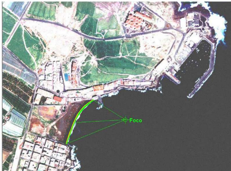
Ajuste de parábola a la costa. Parámetros de la parábola: \beta=66,367^\circ ; R_f=280.40 m.
